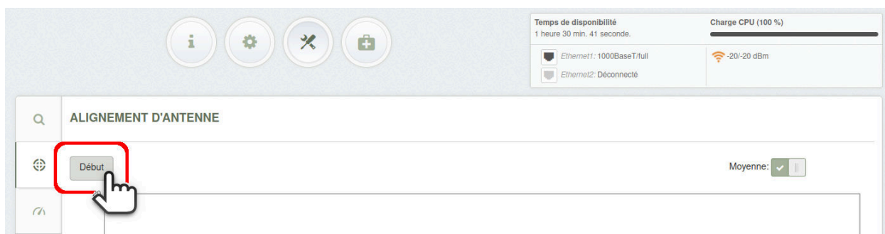
Fig. 42 : Démarrage de l'alignement d'antenne
